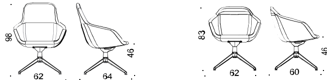
Art 32H/32M: 4-vingat aluminiumstativ glidfötter och vipp, roterbart, fast höjd / 4-wing aluminum base with glides, swivel and tilt, fixed height.
