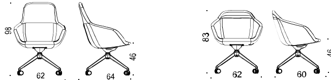
Art 31H/31M: 4-vingat aluminiumstativ med hjul och vipp, roterbart, fast höjd / 4-wing aluminum base with castors, swivel and tilt, rotatable, fixed height.
